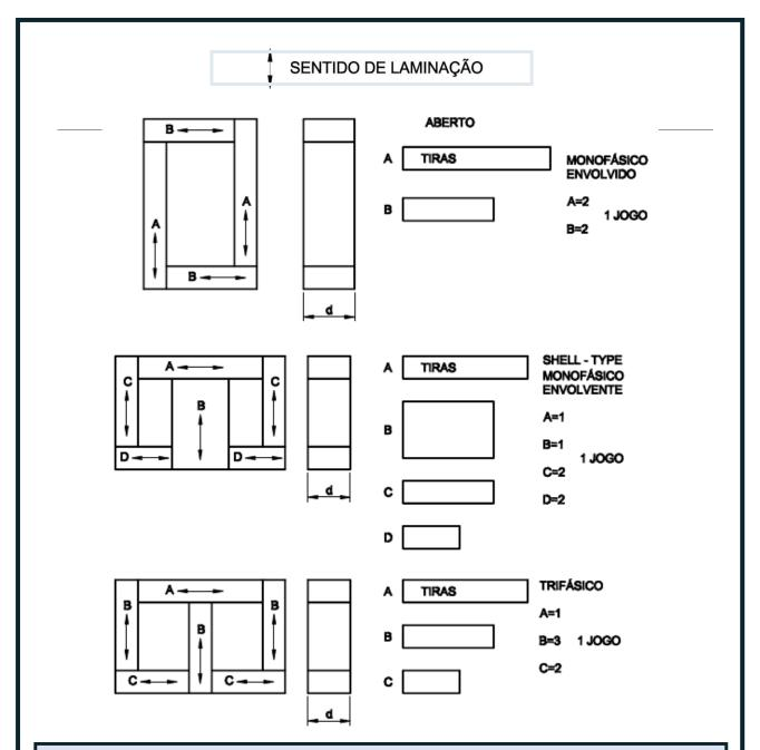
Fornecemos os núcleos mediante medida do cliente em GRÃO ORIENTADO (GO) e GRÃO NÃO ORIENTADO (GNO) para fabricação de transformadores, conforme ilustrações acima. (Corte e Tratamento Térmico)
